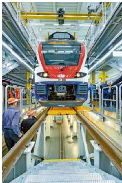
Arbeiten auf drei Ebenen: Von unten, auf Gleishöhe und von der Empore aus auf Dachhöhe. Drei 150 Meter lange Kompositionen haben Platz. Enzo Lopardo
